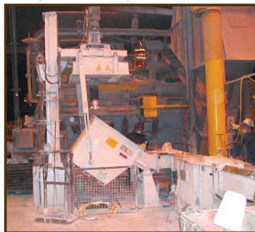
Рис. 11: Установка SNIF® TD 1500, наклоненная для слива металла в конце отливки
