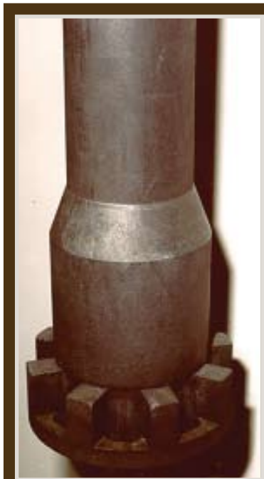
Рис. 5: Продувочное устройство SNIF® SHEER с нижней лопастью
