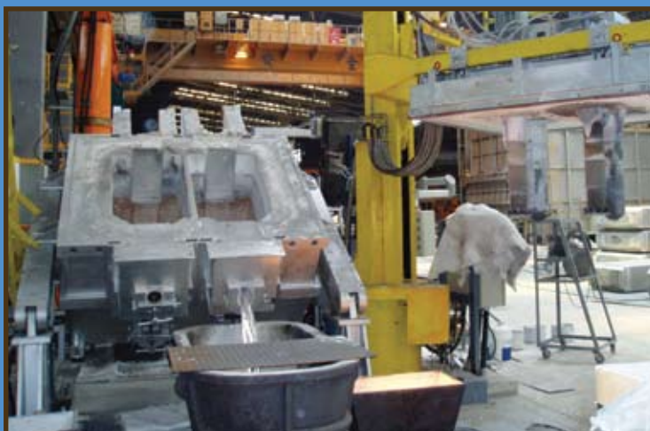
Рис. 10: SNIF® SHEER P140, вращающийся подъемник и печь, наклоненная назад в козел
