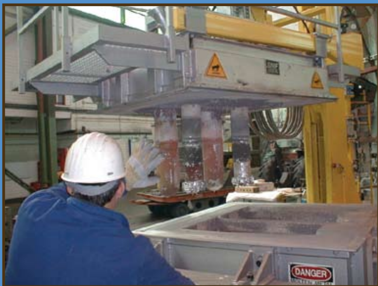
Рис. 9: Система с погружным нагревателем SNIF и вращающийся подъемник крышки
