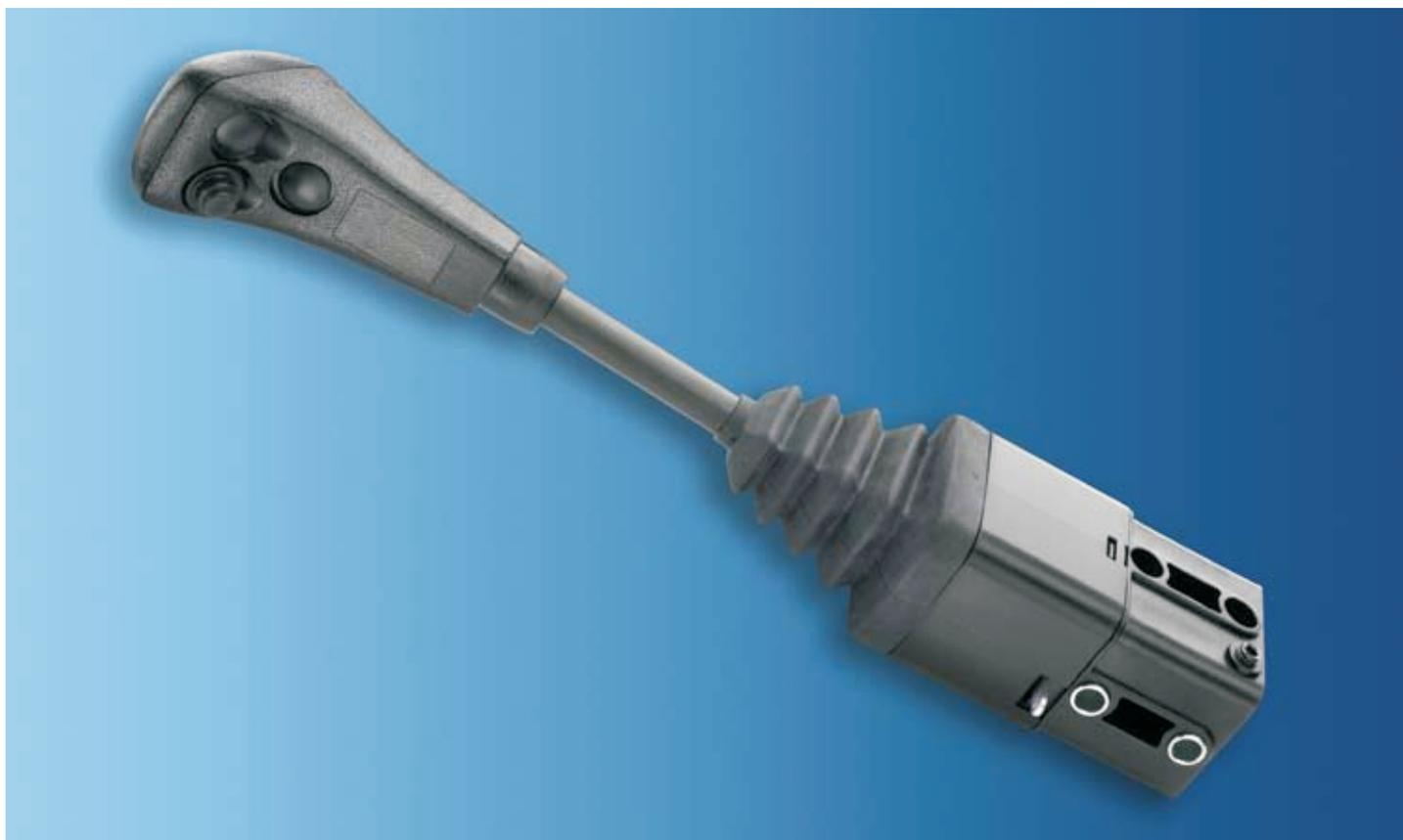
Система управления DA3000 отличается высоким качеством и используется для осуществления дистанционного управления двумя гидравлическими клапанами, в частности системами фронтального погрузчика трактора. Данное устройство легко монтируется в кабину водителя и подключается к гидроклапанам с помощью наших тросов управления.
