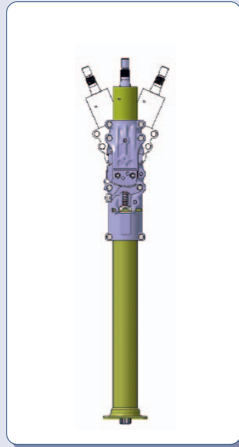
Колонка с высокой осью поворота (HTC) – рулевая колонка с регулировкой угла наклона
