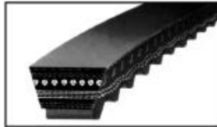
optibelt MARATHON 2 M=S Kfz-Keilriemen - flankenoffen, form- gezahnt, wartungsfrei, satzverwendbar
